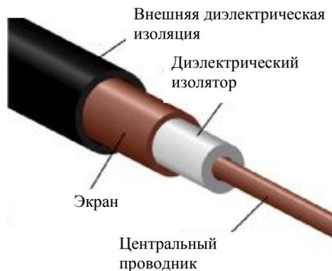
Рис.2. Коаксиальная линия передачи
