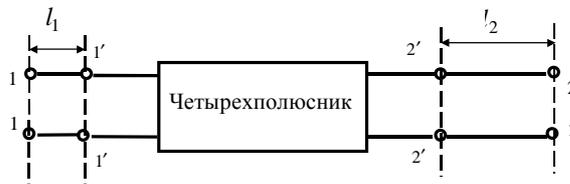
Рис.2. Схема четырехполюсника со смещенными клеммными сечениями
